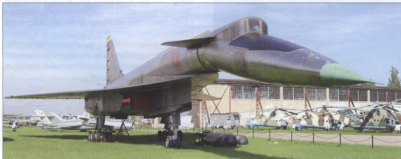
Носовая часть фюзеляжа самолета Т-4 могла отклоняться вниз для обеспечения экипажу хорошего обзора на взлете и посадке
