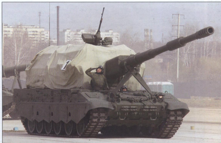
«Коалиция» на репетиции Парада Победы. На крыше необитаемой башни установлен дистанционно управляемый пулемет
