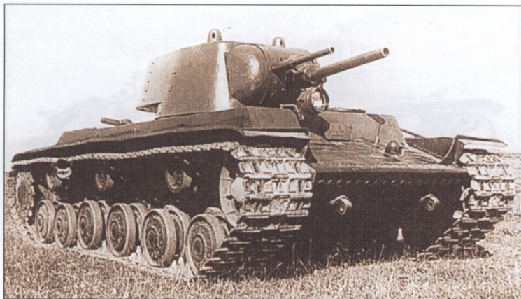
Первый опытный танк КВ с двумя пушками в башне. Перед отправкой на войсковые испытания 45-мм пушку сняли
